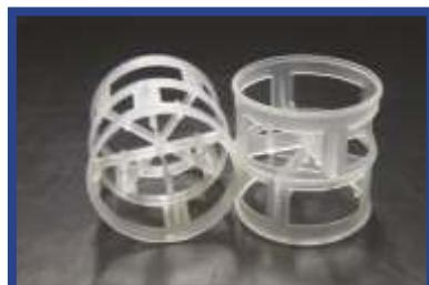
PP malzemeden enjeksiyon yöntemi ile imal edilir. Su soğutma kulelerinde soğutma dolgusu olarak kullanılır. Absorbsiyon kulelerinde ise; arıtmaya yönelik olarak gazın sıvı ile temas yüzeyini artırır. Gazı yıkayıp yoğuşturmak suretiyle, koku giderir ve zararlı atıklardan arınmasını sağlar.
